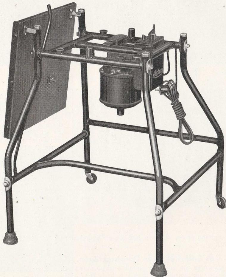
Obwohl die ASTRA-Maschinen, soweit sie nicht mit elektrischem Antrieb ausgerüstet sind, auf jedem Tisch oder Pult aufgestellt werden können, ist die Anschaffung eines aus Stahlrohr gebauten ASTRA-Gestells sehr zweckmäßig. Die Maschine ist mit ihren Gummifüßen in die Schalen des Gestelloberteiles zu stellen und wird dann selbsttätig durch einschnappende Klinken gegen ein Herabfallen gesichert. Der Tisch besitzt an der linken Seite eine aufklappbare Platte zum Auflegen der Bücher und Listen.
