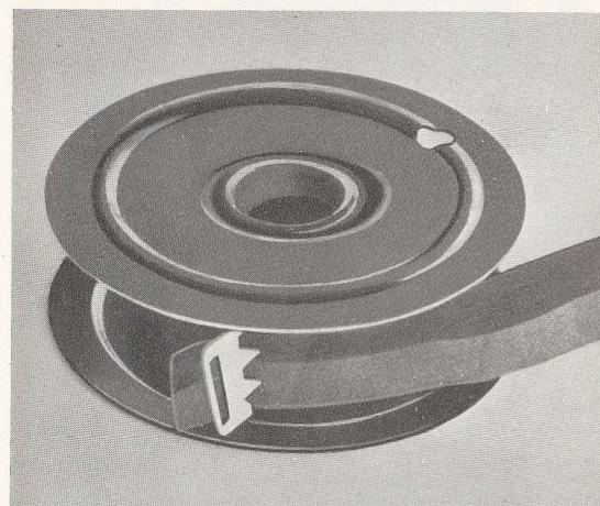
Um ein neues Farbband aufzulegen, wickle man nach dem Öffnen der Farbbandkappe das alte von den Spulen ab. Nun befestige man das eine Ende des neuen Farbbandes an der Klammer einer der leergewordenen Spulen, die man dann so weit dreht, bis das neue Band nahezu aufgewickelt ist. Jetzt leite man das noch freie Ende in der hier gezeigten Weise durch die Führung und befestige es an der Klammer
