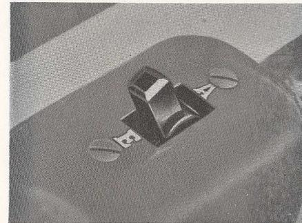
Rechts oben am Gestell (in unmittelbarer Nähe der Handkurbel der aufgesetzten Maschine) befindet sich ein Kipphebel-schalter, der auf die Stellung „E“ (Ein) oder „A“ (Aus) zu bringen ist.
