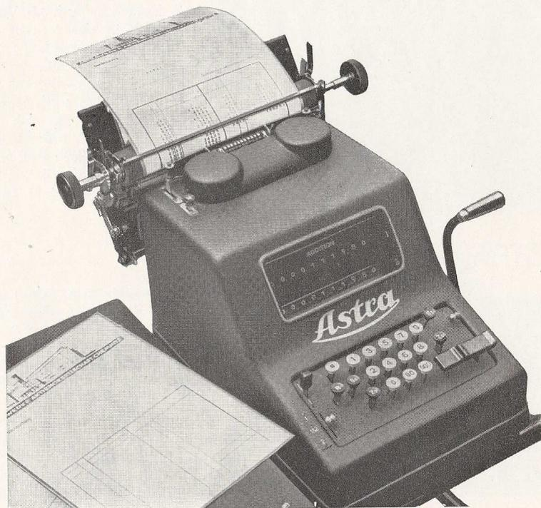
Schüttelsprung-Feststellaste. Der Hebel ist von einem Metallplättchen eingefafst, das vorn die Bezeichnung „W“ und hinten die Bezeichnung „N“ trägt. Von der Stellung dieses Einstellhebels ist nun die Arbeitsweise der Maschine abhängig und es ergibt sich dabei folgendes Schema:
