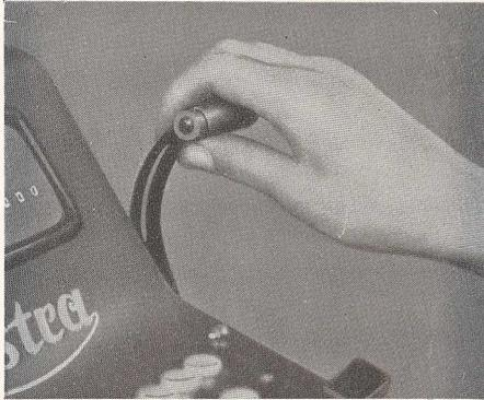
Obwohl die ASTRA-Saldiermaschinen in den meisten Fällen mit elektrischem Antrieb geliefert werden, ist die Kurbel nicht bedeutungslos, denn sie ermöglicht die Bedienung der Maschine auch beim Versagen des elektrischen Stromes. Ferner leistet die Handkurbel auch beim Einstellen der Maschine gute Dienste.
