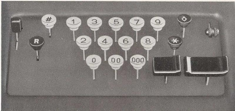
Dieser Tastenaufbau ist sehr geschickt und außerordentlich wichtig. Er ist der natürlichen Stellung der Finger ausgezeichnet angepaßt und macht es möglich, alle Tasten und Hebel nur mit der rechten Hand zu bedienen. Außerdem hat diese sinnvolle Anordnung der Tasten das „Blindschreiben“ (nähere Beschreibung s. Seite 13) der Zahlen zur natürlichen Folge.
