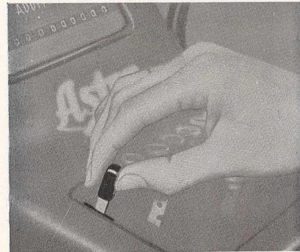
Wurde eine falsch eingesetzte Zahl bereits gedruckt und zugezählt, so muß man sie durch Abziehen aus der Maschine entfernen, was unter Punkt 13 beschrieben ist.
