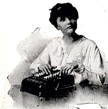
Ceci montre le blocage du clavier. Une touche enfoncée bloque toute la colonne.
