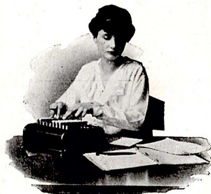
Le clavier verrouillé empêche toute fausse manipulation au cours d'une multiplication.
